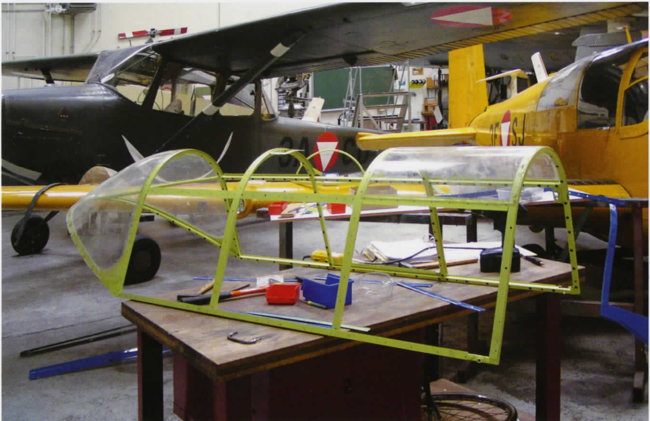
Die Cockpithaube der Zlin wurde komplett zerlegt und neue Plexiglasscheiben eingeschnitten; im Hintergrund die L-19 3A-CD und Safir 3F-SJ als Lehrmittel.
