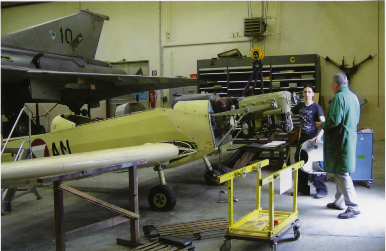
Anpassen der Motorverkleidungsbleche der Zlin: die Frontmaske ist eine unter hohem Arbeitsaufwand hergestellte Neuanfertigung; links der Draken 10 der Schule.
