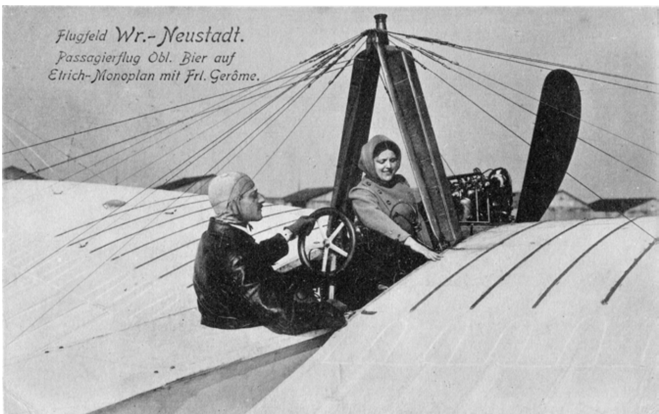
Abb. 2: Passagierin Frieda Gerôme und Pilot Oberleutnant Heinrich Bier in seiner Etrich Taube „Etrich VII“ mit 65 PS (48 kW) Austro-Daimler Flugmotor, bereit zum Start am 4. Mai 1911 am Flugfeld in Wiener Neustadt. Postkarte: A. Kuderna/1295:1911 [Ch. Reiterer via M. Zelezny]
